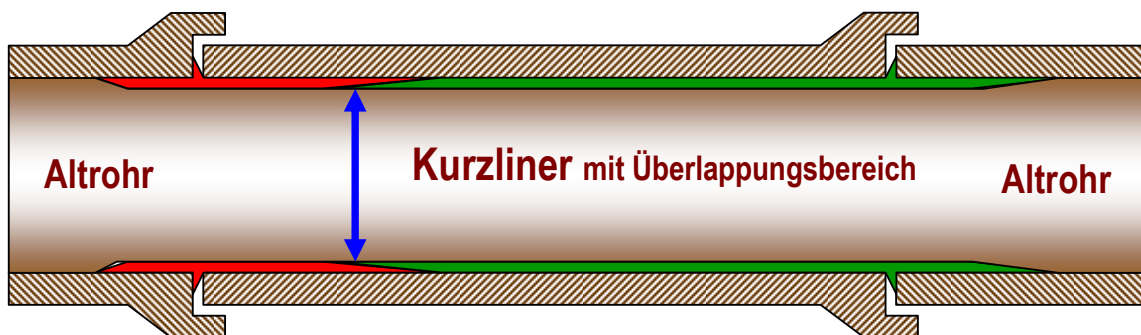
Abbildung 1 Kurzlinier über ganze Rohrlänge mit Überlappungsbereich
