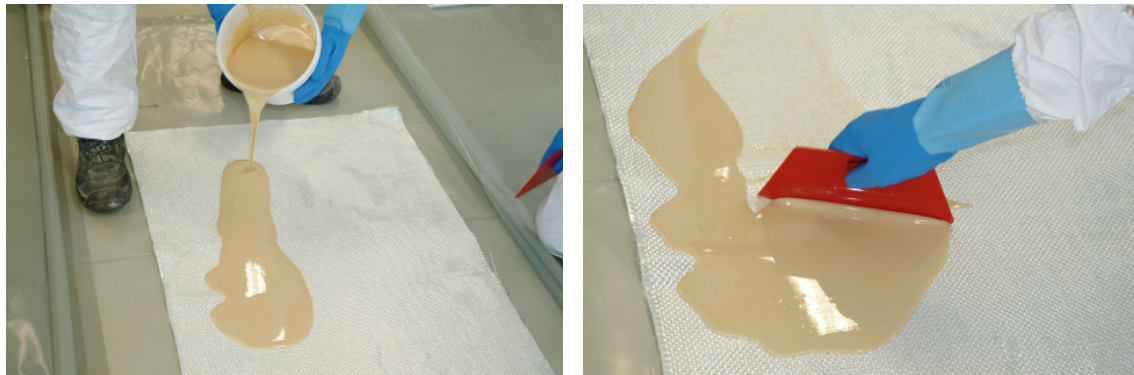
Abbildung 7 Laminieren der Glasfasergewebematte
