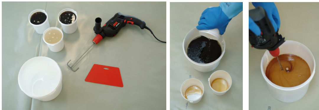
Abbildung 5 Anmischen der Harzkomponenten Konudur 250 OM-PL
