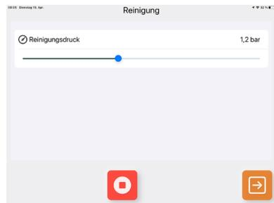
Nach 30 Sekunden ist der von der App vorgegebene Reinigungsmodus beendet und geht in die manuelle Luftdruckregelung zur weiteren Reinigung über. Der Luftdruck wird anschließend von dem/der Anwender/in so weit runtergefahren, dass der Sprühkopf mit dem Finger angehalten und aus dem sanierten Rohr entnommen werden kann.
