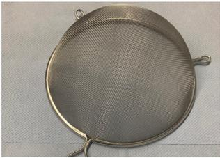
Dann werden die Komponenten A (großer Tank/rot gekennzeichnet) und B (kleiner Tank/ blau gekennzeichnet) durch die Materialsiebe in die farblich gekennzeichneten Tanks der Anlage eingefüllt. Es ist darauf zu achten, dass jede Komponente ein eigenes Sieb erhält.
