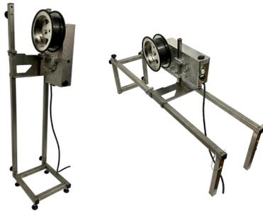
Das Moverstativ sorgt für die punktgenaue Fixierung des Movers vor dem Rohranfang. Das Stativ kann sowohl flach liegend, beispielsweise für Flachdach-Sanierungen, sowie aufrecht stehend, für Hausanschluss-Sanierungen, angebracht werden.
