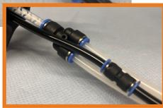
Zur Vorbereitung des Sprühvorgangs wird der Sprühkopf inklusive der originalen Polypipe Mischeinrichtung mit den Schlauchenden der Komponenten A und B sowie der Druckluft verbunden.
