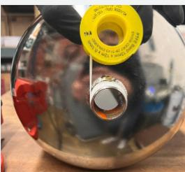
Das Materialsieb lässt sich mit einem 17er Inbusschlüssel herausschrauben und mit PU-Reiniger säubern. Die Wiedermontage erfolgt in umgekehrter Reihenfolge wie die Demontage. Zuvor ist der 1" Gewindestutzen am Tank mit Teflonband einzudichten.
