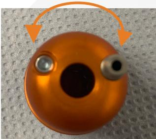
Die Drehrichtung des Sprühkopfs kann durch das Austauschen des Druckluftanschlusses mit der Madenschraube erfolgen.
