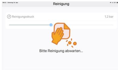
Nach dem jeweiligen Beschichtungsvorgang wird der Materialfluss von dem/der Anwender/in am RabbitControl gestoppt. Danach startet automatisch der Reinigungsmodus (30 Sekunden).
