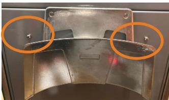
Zur Reinigung der Materialtanks und der darin befindlichen Materialsiebe müssen die Tanks entnommen werden. Dazu muss die Geräterückwand inklusive der Schlauchhalterung vom RabbitCoater entfernt werden. Es sind die beiden Inbusschrauben rechts und links neben dem Schlauchhalter zu entfernen, um dann die Geräterückwand entnehmen zu können.
