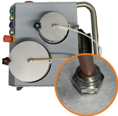
Alle Schnellkupplungen, welche mit den Harzkomponenten in Verbindung kommen, müssen regelmäßig mit PU-Reiniger gereinigt werden. Die Schnellkupplungen können hierzu leicht mit einem 14er Maulschlüssel jeweils aus den Tankdeckeln und den Materialschlauch-Verschlussstücken entfernt werden, um gereinigt zu werden.
