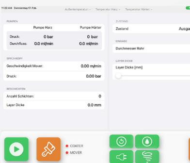
Nach Eingabe aller Baustellen- und Rohrleitungsinformationen wird der Positionierdruck in der RabbitControl App aktiviert und der/die Anwender/in führt den Sprühkopf samt Schlauchpaket und passendem Zentrierring hinter die zu sanierende Stelle im Rohr ein.
