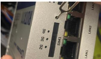
Jetzt wird mit der Nadel der SIM-Slot 1 geöffnet und die SIM Karte eingesetzt. Der Slot wird wieder verschlossen und das Modul wieder eingesetzt. Die Fronttüre ist wieder zu verschließen.
