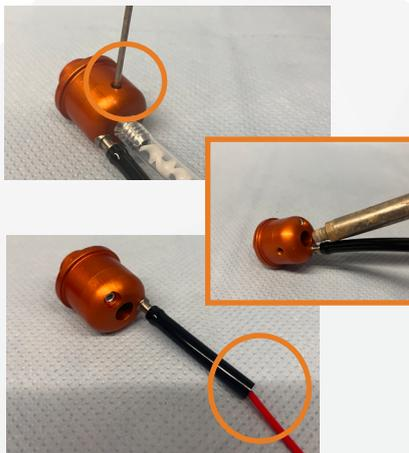
Die Madenschraube, welche den Zwangsmischer fixiert, liegt nun frei und wird mit einem Inbusschlüssel gelöst, damit der Zwangsmischer aus dem Sprühkopf entnommen werden kann. Anschließend wird mittels PU-Pistole der Reiniger in die Öffnung gesprüht.
