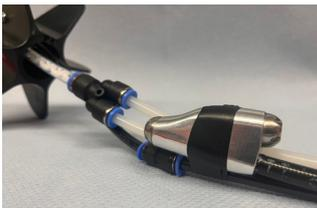
Zur optischen Überwachung des Sprühvorgangs wird auf dem Schlauchpaket, hinter dem Sprühkopf, eine Kamera montiert. Die Kamera ist so zu positionieren, dass der Sprühkopf kontrolliert werden kann.
